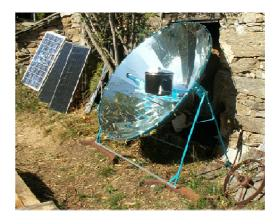
(d) Solar cooker with parabolic reflector
